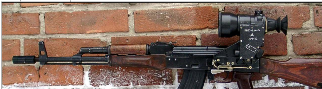
Выверка ночного прицела 1ПН93 на автомате АКМН с использованием ЛПУ
