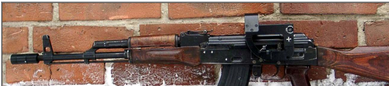
Выверка дневного коллиматорного прицела «Оса» на автомате АКМН с использованием ЛПУ
